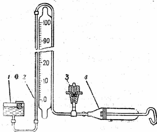
Рис. 84. Схема проверки герметичности топливного клапана:
