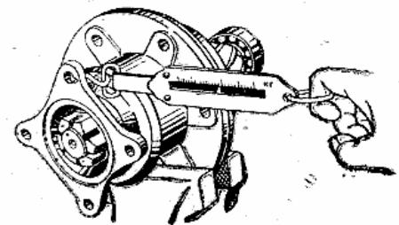
Для этого муфту зажимают в тиски, за отверстие фланца зацепляют крючком динамометра и плавно поворачивают шестерню. Показание на шкале динамометра должно находиться в пределах 2,9—5,1 дан (2,9—5,1 кгс).
