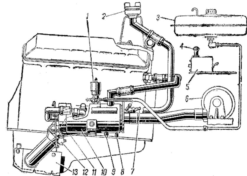
Рис. 21. Установка пускового оборудования:
