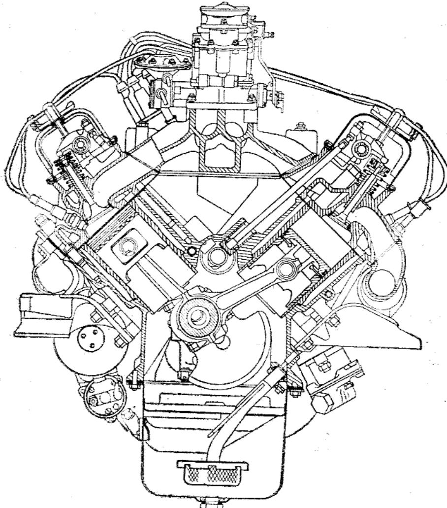
Рис. 4. Поперечный разрез двигателя
