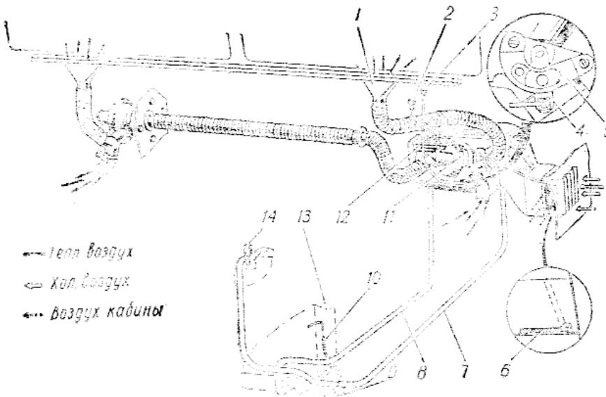
Рис. 76. Отопитель кабины:
