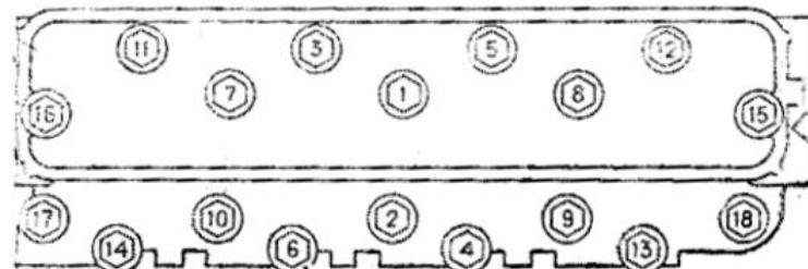
Рис. 7. Порядок затяжки гаек головки цилиндров.
