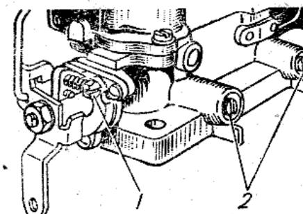
Рис. 87. Винты регулировки холостого хода:
