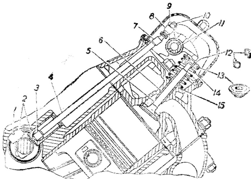
Рис. 10. Механизм привода клапанов:
