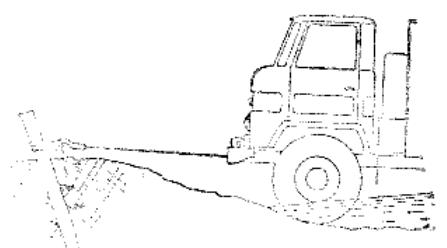
Рис. 69. Самовытаскивание автомобиля с помощью лебедки
