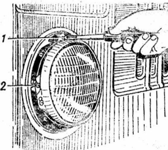
Рис. 99. Регулировка установки фар:
