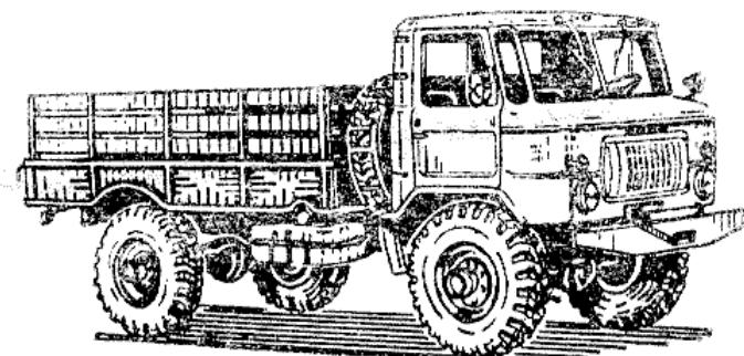
ГАЗ-66-14 — с экранированным электрооборудованием;
