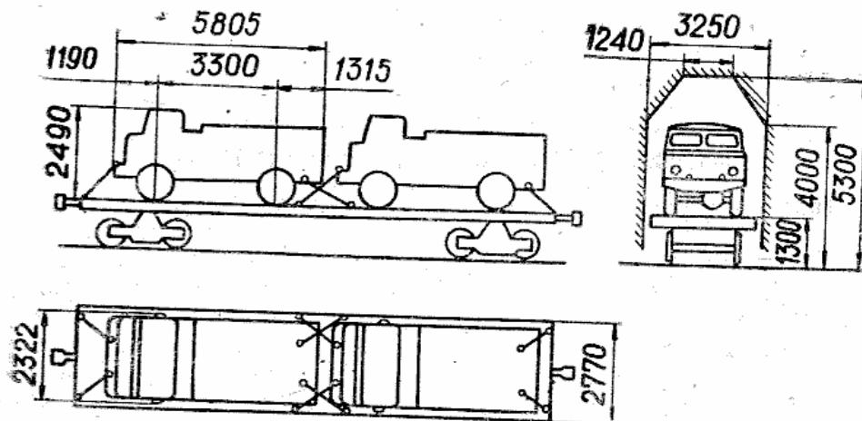
Рис. 101. Схема погрузки автомобилей на железнодорожную платформу
