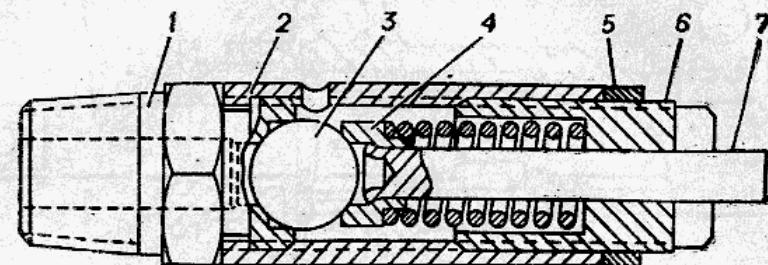
Рис. 38. Предохранительный клапан:
