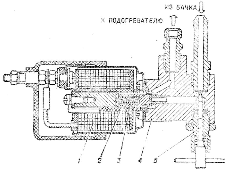
Рис. 22. Электромагнитный запорный клапан:
