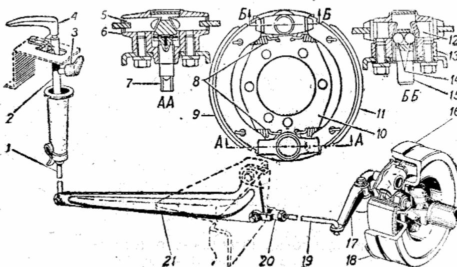
Рис. 97. Стояночная тормозная система:
