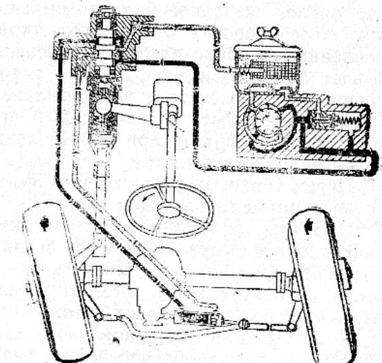
Рис. 46. Схема работы гидроусилителя рулевого привода при повороте налево
