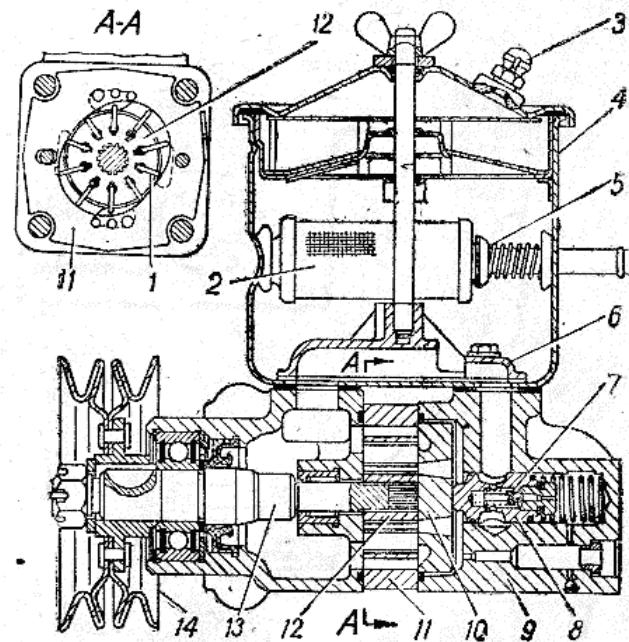
Рис. 43. Насос гидроусилителя рулевого привода:
