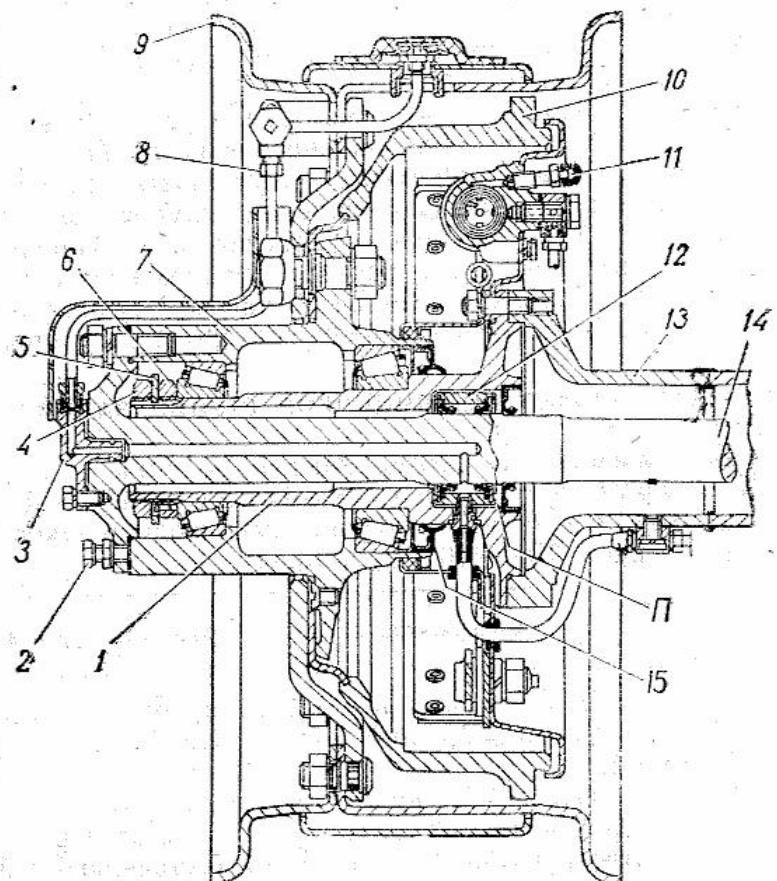
Рис. 90. Задняя ступица и колесо:
