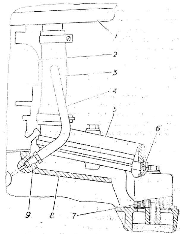
тельная, действующая за счет разрежения во впускной трубе и в воздушном фильтре. При работе двигателя на частичных нагрузках газы из картера отсасываются во впускную трубу, на полных нагрузках — воздушный фильтр и впускную трубу.
