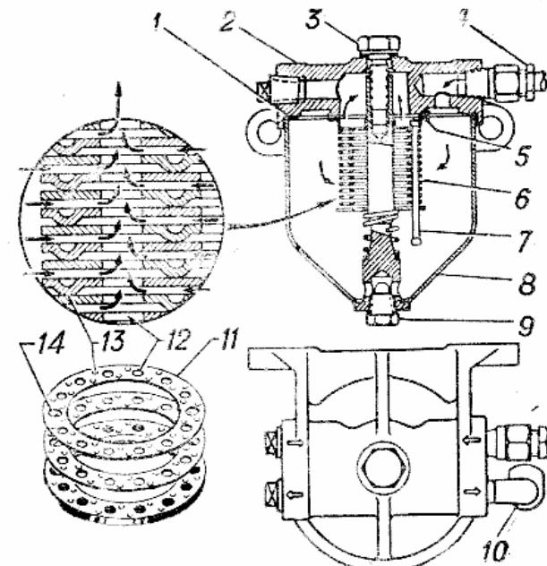
элемента. Для промывки элемента необходимо отвернуть болт 3 на крышке отстойника и снять корпус 8 вместе с фильтрующим элементом 6. Промыв элемент в неэтилированном бензине, нужно установить его на место и затянуть болт 3. При разборке отстойника важно не повредить прокладки 1 и 5, обеспечивающие герметичность корпуса.
